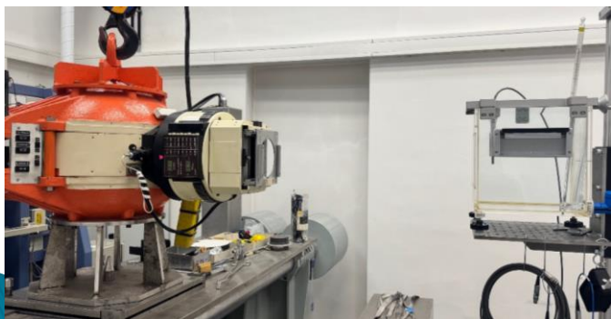
Kalibrace v dávce ve vodě ve svazku ^{60}\text{Co}
