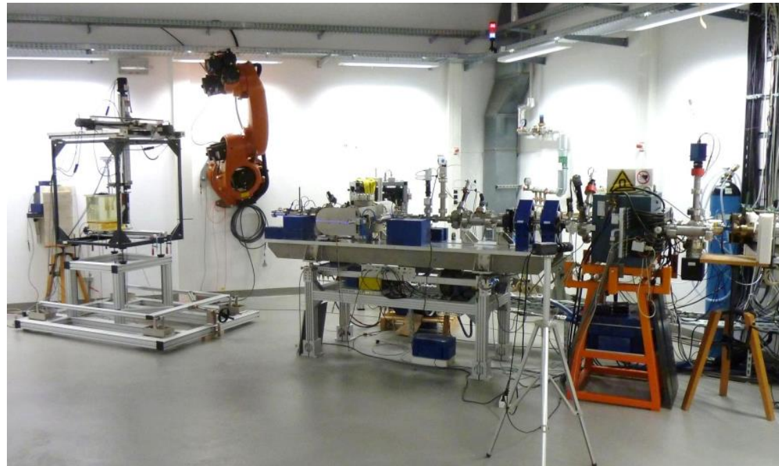
Primární etalon absorbované dávky ve vodě od elektronového UHD svazku v PTB, Německo.
